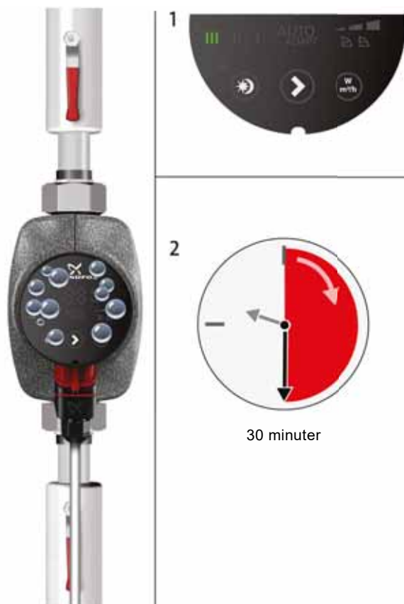
Fig. 8 Avluftning av pumpen
