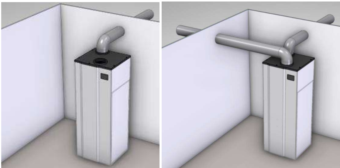
Illustration; Exempel på installation av luftkanaler
