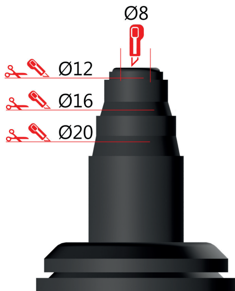
Kapning av rör genomföring för golvvärmerör.
