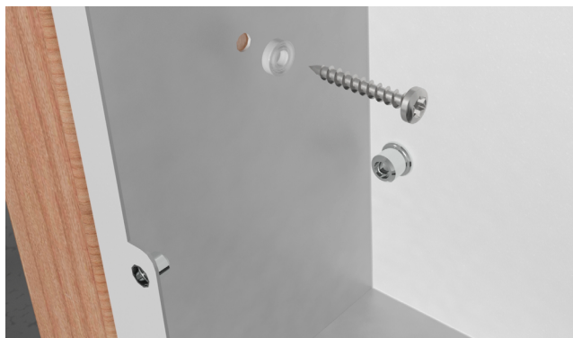
Infästning av skåp i regelvägg.
